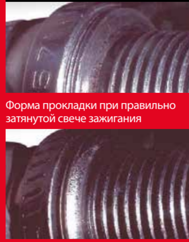
Форма прокладки при недостаточно затянутой свече зажигания
